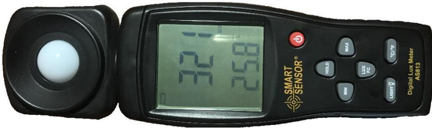
Рисунок 2 – Люксомер фирмы Smart Sensor
