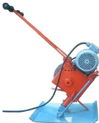
Рисунок 1– Общий вид ручной виброплиты с МПС
