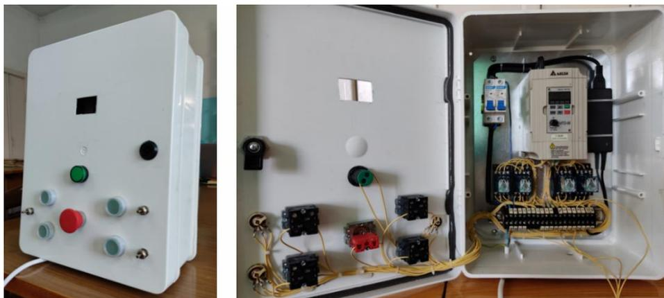
Рисунок 5 – Общий вид пульта управления механизмом подачи инструмента буровой машины
