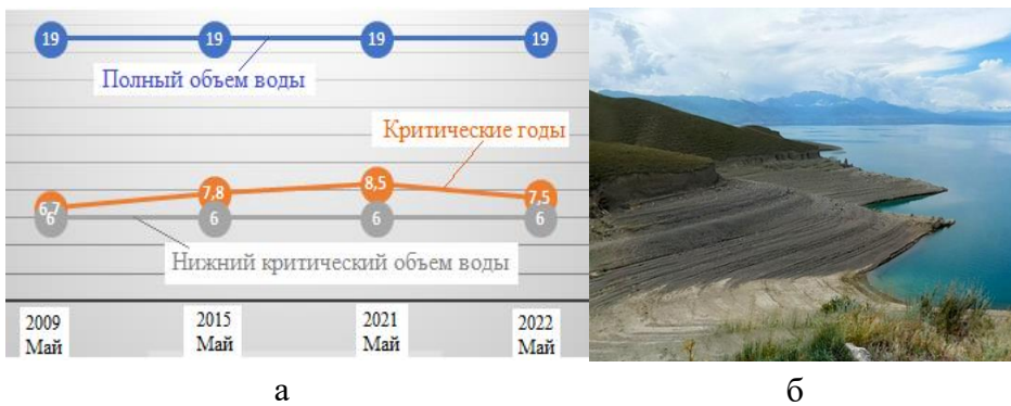
Рисунок 5 – Динамика изменения объема воды в водохранилище Токтогульской ГЭС: а – динамика приближения к нижней критической отметке, б – следы опускания уровня воды
