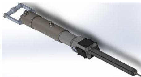
Рисунок 2 – Гидравлическое клиновое устройство
