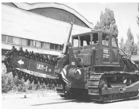
\*\* Цепная камнерезная машина ЦКМ-1м
