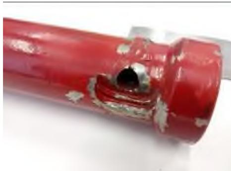
Рисунок 3 – Характерное место поломки крепления фиксатора
