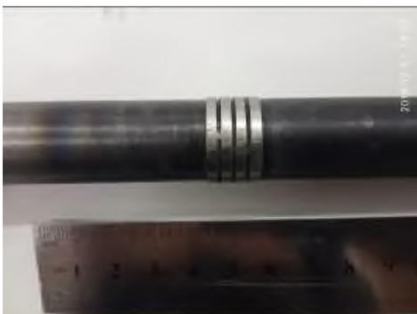
Рисунок 5 – Характерный износ сопрягаемой поверхности бойка
