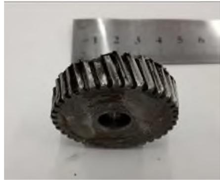
Рисунок 2 – Смятие зубчатого колеса отбойного молотка
