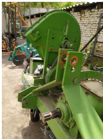
Рисунок 3 – Место переделки крепления центрального винта
