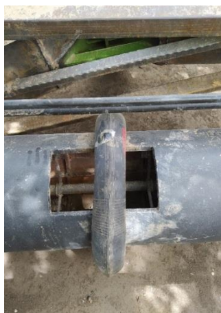
Рисунок 9 – Барабан для укладки пленки, покрытый резиной
