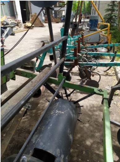
Рисунок 10 – Место крепления рулона полиэтиленовой пленки
