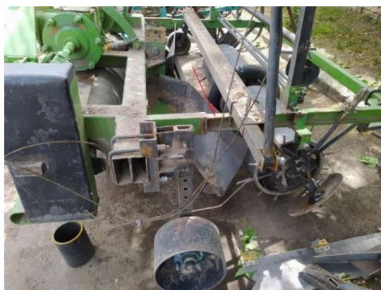
Рисунок 4 – Место удлинения задней части рамы
