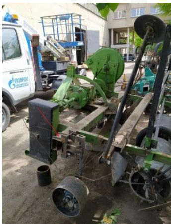
Рисунок 2 – Переделка рамы под крепление опорных колес
