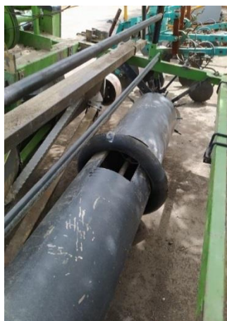
Рисунок 9 – Барабан для укладки пленки, покрытый резиной
