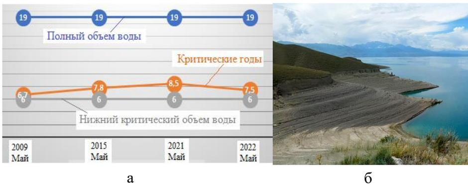
Рисунок 5 – Динамика изменения объема воды в водохранилище Токтогульской ГЭС: а – динамика приближения к нижней критической отметке, б – следы опускания уровня воды
