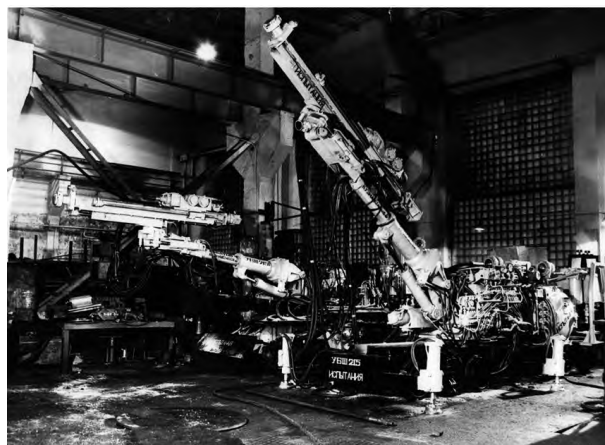
Рисунок 7 – Первые серийные образцы бурового агрегата УБШ-214 (справа) и УБШ-215 (слева) на рельсовом ходу
