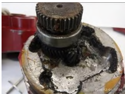
Рисунок 2 – Смятие зубчатого колеса отбойного молотка
