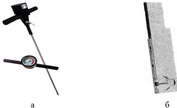
Рисунок 4 – По направлению измерения твердости почвы: вертикальное измерение (а); по высоте обработки почвенного пласта (б)
