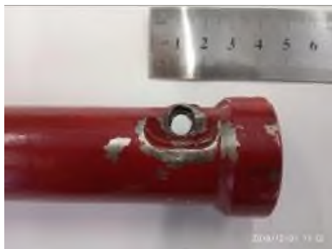
Рисунок 3 – Характерное место поломки крепления фиксатора
