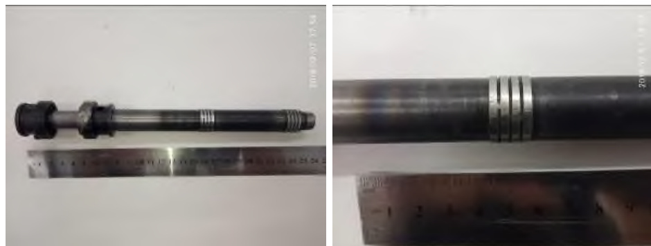
Рисунок 5 – Характерный износ сопрягаемой поверхности бойка
