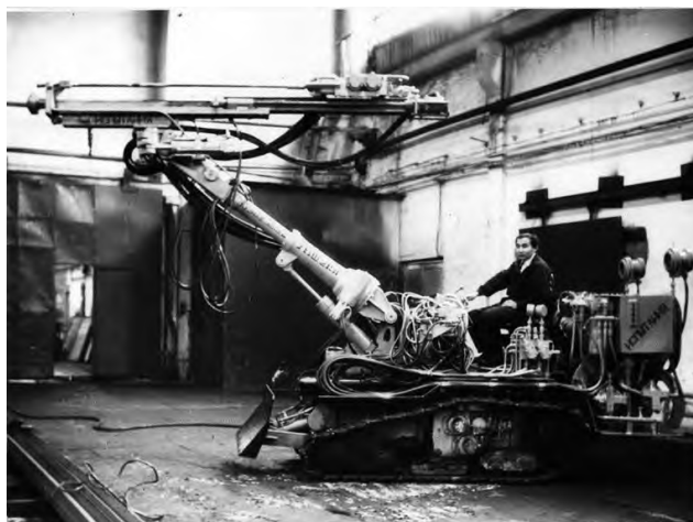
Рисунок 6 – Первый серийный образец бурового агрегата УБШ-215 на гусеничном ходу
