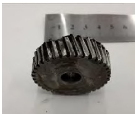
Рисунок 2 – Смятие зубчатого колеса отбойного молотка
