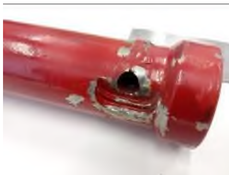
Рисунок 3 – Характерное место поломки крепления фиксатора
