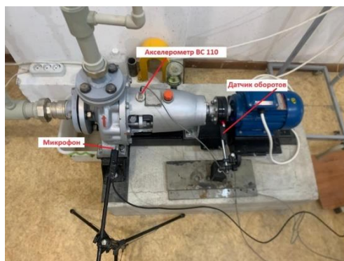
Рисунок 4 – Датчики на установке для экспериментального исследования центробежного консольного насоса
