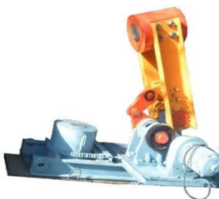
г) Механический генератор ударных импульсов высокой мощности ГУИМ – 1
