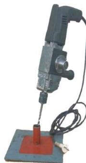
в) Механический перфоратор ручной МПР-4
