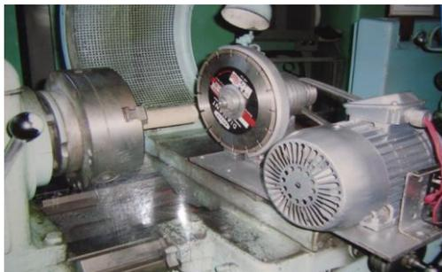
Рисунок 5 – Технологический модуль с дисковым алмазным инструментом
